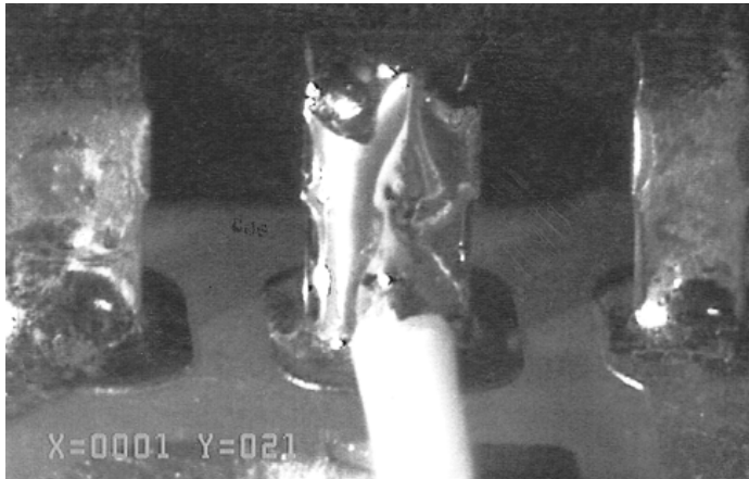
Acceptable – Niveaux A, B, C Joint brasé acceptable au niveau du fil.
